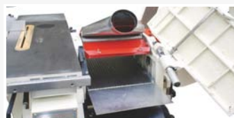
● Función regruesadora levantando mesas de cepillar, bloqueo de seguridad
