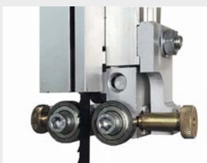
Guía cinta superior e inferior a rodamientos con ajuste.
