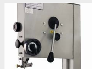
Palanca de destensado rápido de la cinta.
