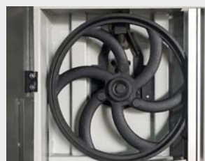
Volantes de radios fabricados en fundición.
