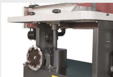
Sistema de volante para la mesa elevable.
