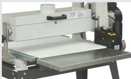
Permite lijar piezas hasta un ancho máximo de 560 mm, altura regulable de 0 a 75 mm. MS 3157
