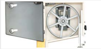
• Volantes de radio en fundición de aluminio
