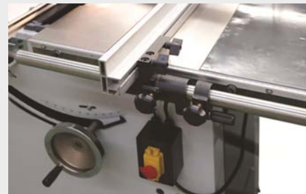
● Regulación micrométrica guía lateral
