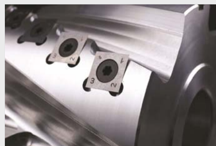
Eje portacuchillas en doble espiral con cuchillas MD
