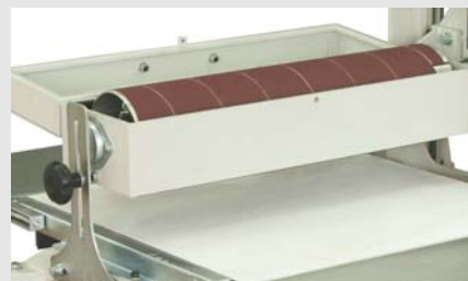
● Usa lija en rollo standard, fácil manipulación para el cambio de abrasivos. MS 3157
