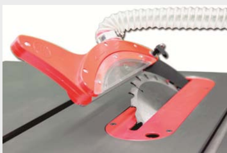
Inclinación hasta 45° con inserto normal y DADO
