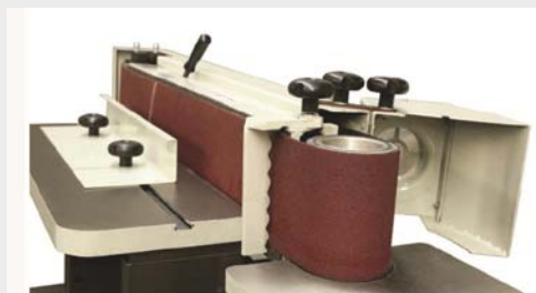
Lijado libre en final rodillo con mesa ajustable.
