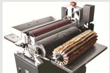
Se pueden montar lijas normales o 3 tipos de rodillos opcionales- Montaje rápido.
