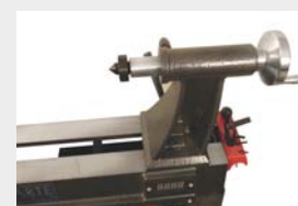
Contrapunto y almacén para las herramientas.
