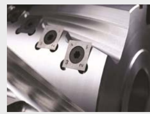
Eje doble espiral con cuchillas MD
