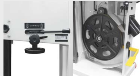
Volantes en fundición. Freno de pedal. Indicador de tensión de cinta. Cambio rápido de cinta.
