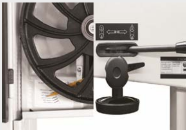
Indicador de tensión según ancho cinta Palanca cambio rápido de cinta
