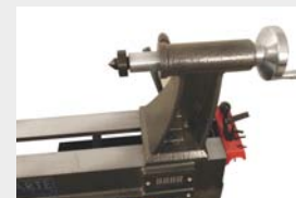
Contrapunto y almacén para las herramientas
