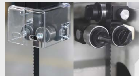
Guía cinta profesional, guía inferior con ajuste rápido
