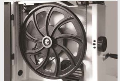
Volantes de radios en fundición. Indicador de tensión de cinta.
