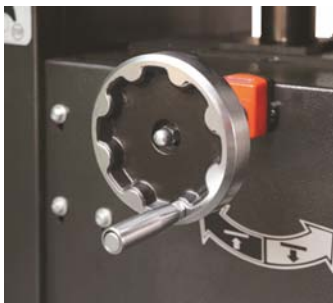
Volante de acero y contador decimal.
