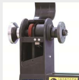
Dos velocidades por correa y control electrónico en las dos velocidades (1224VDX)
