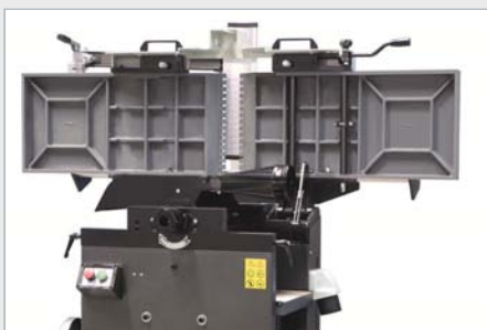
Sistema de mesas elevables simultáneamente.
