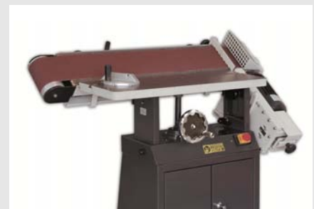
Permite trabajar con la mesa posición de 45° o de 90°. Mesa equipada con guía a ingletes de - 45° a +45°
