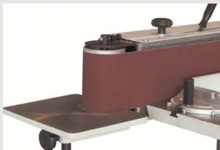
Mesa de apoyo en rodillo que permite trabajar piezas curvas
